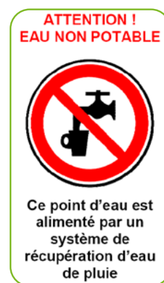
Figure 1 : Panneau d'eau non potable
