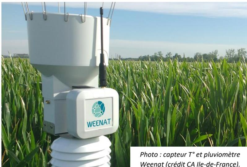
*Photo : capteur T° et pluviomètre Weenat (crédit CA Ile-de-France).*
